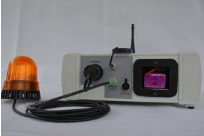
Illustration 3: Ground-FLARM avec sirène et flash d'avertissement vu de l'arrière
