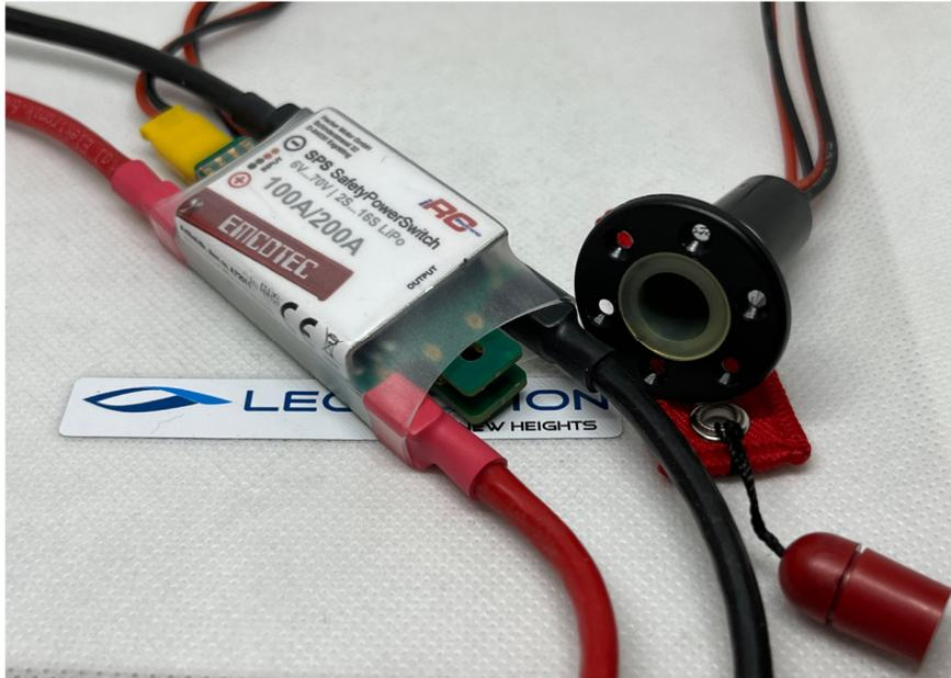
*Interrupteur de sécurité magnétique*
