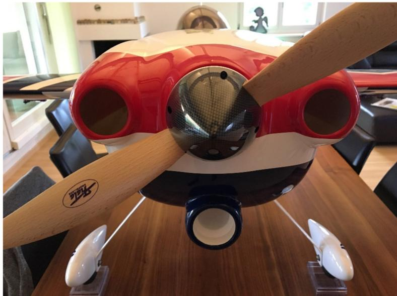
*L'hélice doit TOUJOURS être retirée lors de travaux sur la propulsion armée*
