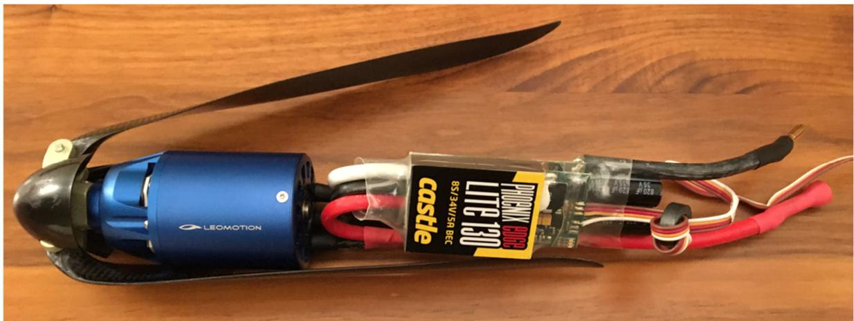
*Souder le régulateur au moteur en gagnant de la place - propulsion de 100A avec régulateur 130A*
