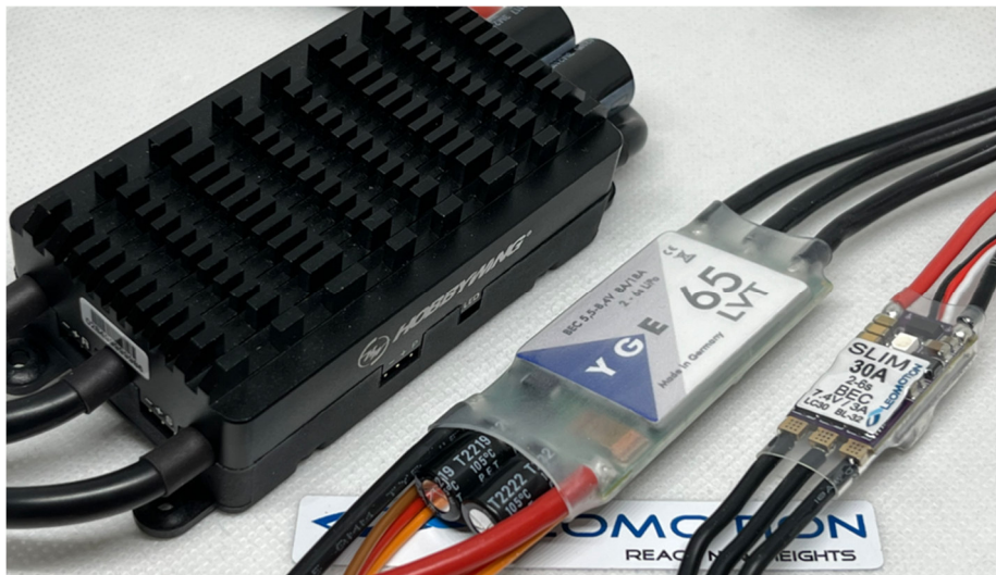
Regler unterschiedlicher Bauform und Stromstärke
