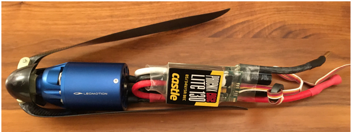
Regler platzsparend am Motor anlöten – 100A Antrieb mit 130A Regler
